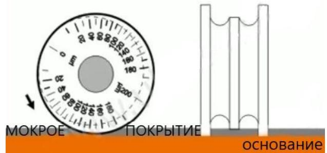
При измерении толщины второго слоя покрытия вдавливать гребёнку необходимо аккуратно, чтобы не повредить первый слой. При измерении толщины мокрого слоя на трубопроводе или аналогичной криволинейной поверхности, гребёнку следует размещать вдоль продольной оси. При измерении толщины мокрого слоя прозрачных красок, достаточно после измерения посыпать зубцы гребёнки тальком и сдуть излишки. Тальк останется только на «мокрых» зубцах.
